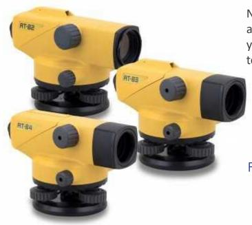
Niveles automáticos duraderos, confiables y de alto valor 3 modelos: aumentos de 32x, 28x y 24x Compensación automática rápida, precisa y estable Enfoque ultracorto de 20 cm (7,9 pulgadas) Confiabilidad en todo clima Ajustes horizontales finos sin fin y sin abrazaderas
